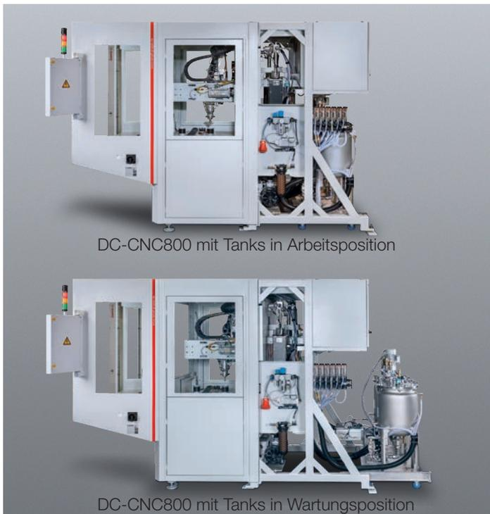
DC-CNC800 mit Tanks in Arbeitsposition
