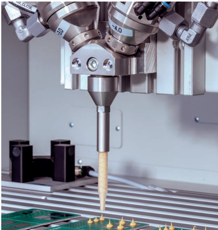
Schlankes Design, vielfältige Möglichkeiten zum Dosieren von Wärmeleitpasten, Vergussmassen und Klebstoffen
