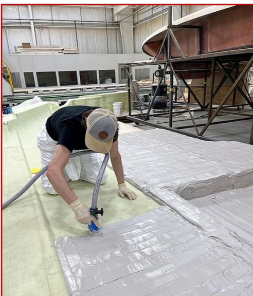
RAKU<sup>®</sup> TOOL Close Contour Pasten von RAMPF sind zweikomponentige Epoxidharzsysteme, die für die direkte Applikation auf endkonturnahe Träger wie EPS, Holz oder das Styling-Blockmaterial RAKU<sup>®</sup> TOOL SB-0064 entwickelt wurden. Dadurch werden Materialverbrauch, Produktionsabfälle sowie Fräs- und Nachbearbeitungszeiten deutlich reduziert.
