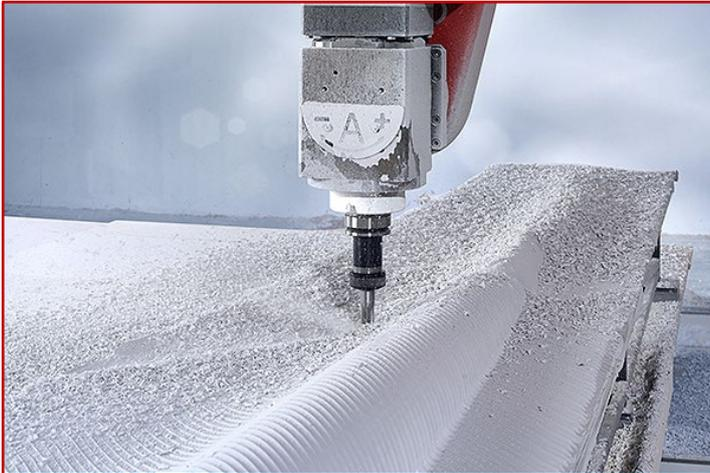
**RAKU<sup>®</sup> TOOL Styling-Blockmaterial** aus Polyurethan bietet eine außergewöhnliche Oberflächenqualität und herausragende Maßhaltigkeit. Das Portfolio umfasst Materialien mit Dichten bis zu 0,5 g/cm<sup>3</sup>, die sich sowohl für die CNC-Bearbeitung als auch manuelle Verarbeitung eignen.
