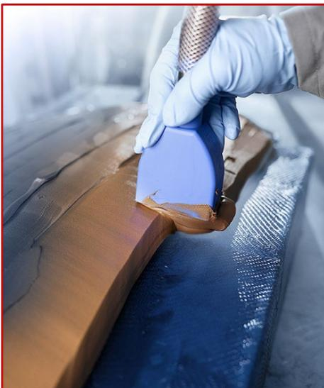
RAKU<sup>®</sup> TOOL Close Contour Pasten von RAMPF eignen sich ideal für den großformatigen Modellbau und stehen für kosteneffiziente und zeitsparende Fertigungsprozesse. Die innovativen Zwei-
