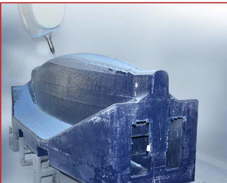
RAKU<sup>®</sup> TOOL Close Contour Castings sind Halbzeuge aus Polyurethan, die als dreidimensionale Gießlinge geliefert werden und bereits nahe an der Endkontur vergossen sind. Diese innovative Technologie ermöglicht eine besonders wirtschaftliche und ressourcenschonende Herstellung von maßstabilen Modellen und Formen. Die Vorteile:
