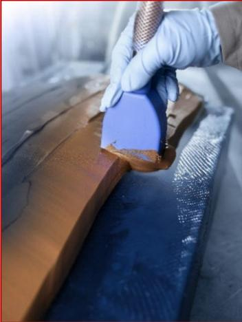
RAKU<sup>®</sup> TOOL Close Contour Pasten sind Zweikomponenten-Epoxid-Systeme, die mit Misch- und Dosieranlagen verarbeitet und aufgetragen werden. Die thixotropen, einfach zu verarbeitenden Materialien ermöglichen die Herstellung maßstabiler, fugenfreier Modelle und Formen. Die Vorteile:
