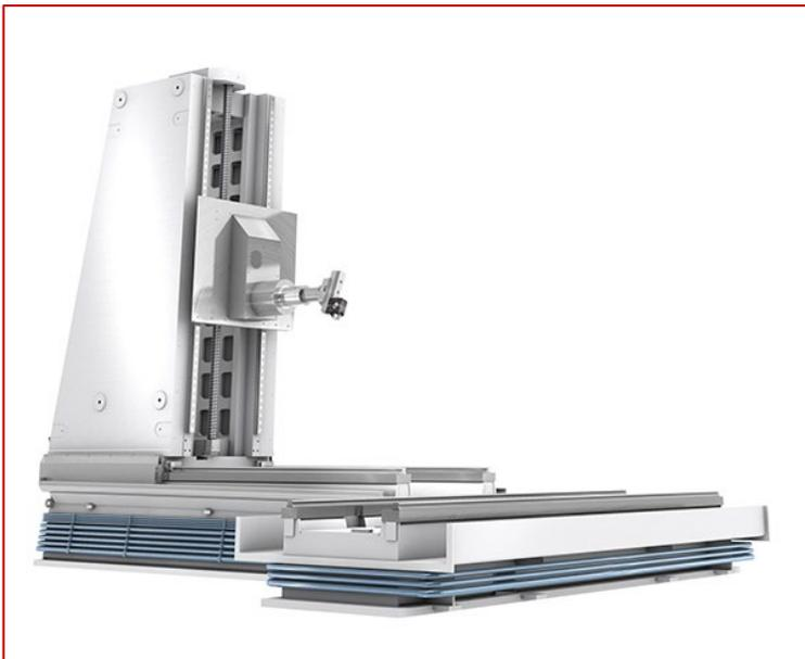
Die Basis für die dauerhafte Genauigkeit der MC $\mu$  ist höchste Stabilität von Grund auf. Dazu zählen hohe Führungsstege und FEM-optimierte Strukturen, die mit EPUMENT<sup>®</sup> Mineralguss ausgegossen sind. Der Hochleistungswerkstoff von RAMPF Machine Systems sorgt für maximale Stabilität in ultrapräzisen Maschinen: Vergleichende Messungen zeigen, dass Mineralguss eine bis zu zehnmal höhere Materialdämpfung als Grauguss und Schweißkonstruktionen aufweist.
