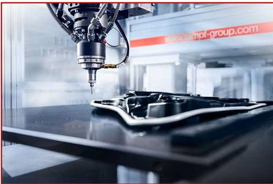
Dichtungssysteme auf Basis von Polyurethan (RAKU<sup>®</sup> PUR) und Silikon (RAKU<sup>®</sup> SIL) gewährleisten eine effiziente und langfristige Abdichtung, erfüllen höchste Qualitätsansprüche und sind einfach zu verarbeiten. Die schnell aushärtenden, emissionsarmen und hitzebeständigen Systeme schützen Batterieabdeckungen, Ladestationen und Ladestecker vor Staub, Schmutz, Feuchtigkeit, chemischen Substanzen und Umwelteinflüssen.
