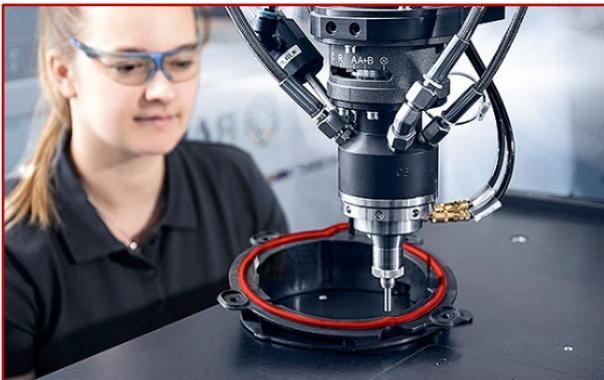
Zwei-Komponenten-Dichtungssysteme – von flüssig bis hochthixotrop – auf Basis von Polyurethan (RAKU<sup>®</sup> PUR) und Silikon (RAKU<sup>®</sup> SIL) gewährleisten zuverlässige Abdichtungseigenschaften und eine prozesssichere, anwenderfreundliche Verarbeitung.
