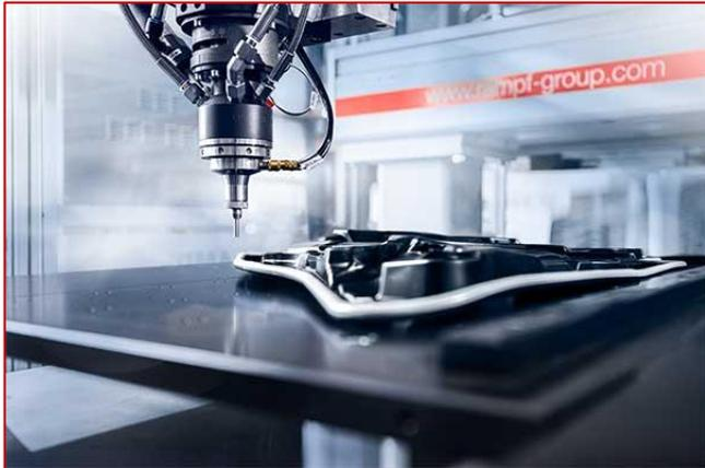
Dichtungsschäume von RAMPF auf Basis von Polyurethan (RAKU® PUR) und Silikon (RAKU® SIL) gewährleisten eine effiziente und langfristige Abdichtung, erfüllen die höchsten Qualitätsansprüche und sind einfach zu verarbeiten. Die schnell aushärtenden, emissionsarmen und hitzebeständigen Systeme schützen Batterieabdeckungen, Ladestationen und Ladestecker vor Staub, Schmutz, Feuchtigkeit, chemischen Substanzen und Umwelteinflüssen.
