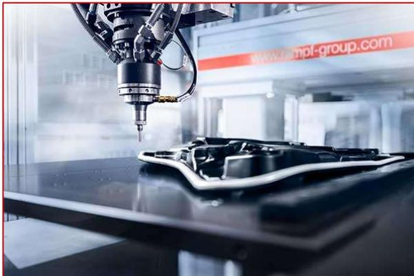
Flüssige bis hochthixotrope sowie kompakte Dichtungen auf Basis von Polyurethan (RAKU<sup>®</sup> PUR) und Silikon (RAKU<sup>®</sup> SIL) schützen maximal und dauerhaft vor Feuchtigkeit, Staub und chemischen Einflüssen.
