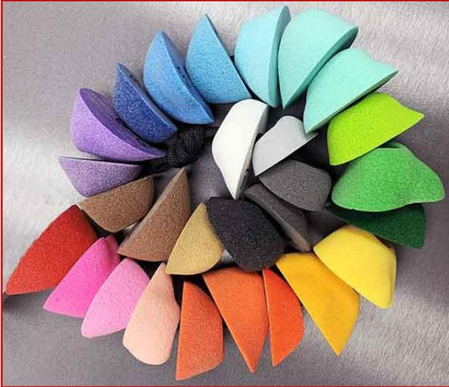
RAKU<sup>®</sup> TOOL IE-3092 ist leicht zu pigmentieren und wird in einer Vielzahl von Standardfarben geliefert.
