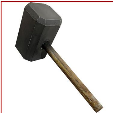
Die Form wurde aus dem niedrigviskosen, hochfesten Zinnsilikon RAKU<sup>®</sup> RS-9225 25A hergestellt. Für den Hammer wurde das leichte, gut schleifbare und einfach zu färbende Polyurethangießharz RAKU<sup>®</sup> TOOL IE-3460 verwendet, das nach RT-Härtung hervorragende physikalische Eigenschaften aufweist.
