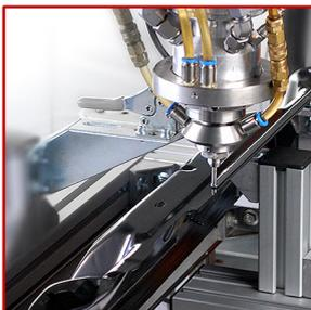
Klebsysteme auf Basis von Polyurethan, Epoxid und Silikon vereinen ultimative Haftung und Festigkeit mit ausgezeichneter Temperatur- und Chemikalienbeständigkeit. Die Kleber wurden speziell entwickelt, um starke, dauerhafte Verbindungen zu schaffen, die den Anforderungen von Automobilanwendungen standhalten.
