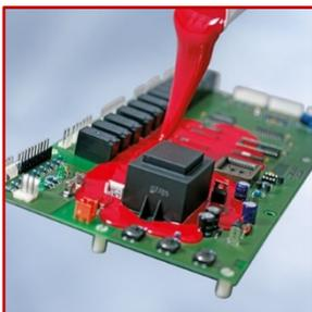
Elektrogießharze auf Basis von Polyurethan, Epoxid und Silikon zeichnen sich durch eine breite Palette mechanischer, thermischer und chemischer Eigenschaften aus. Sie sind ideal für den Verguss empfindlicher Elektronik und das Wärmemanagement in Batteriepacks.
