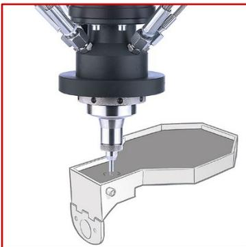
Sensible elektronische Baugruppen werden durch ein- oder mehrstufiges Vergießen dauerhaft vor Berührung, Feuchtigkeit und Beschädigung geschützt. Eine hochwirksame Aufbereitung zur Luftentgasung der ein- und zweikomponentigen Vergussmassen auf Basis von Polyurethan, Silikon oder Epoxidharz gewährleistet einen blasenfreien Vergussprozess.
