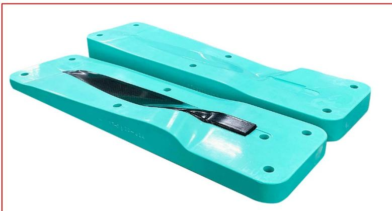
Extrem leicht und stabil – das Propellerblatt wird via Vacuum Assisted Resin Transfer Molding (VARTM) aus dem Blockmaterial RAKU<sup>®</sup> TOOL WB-0700 sowie Hochleistungs-Flüssigharzen von RAMPF hergestellt.
