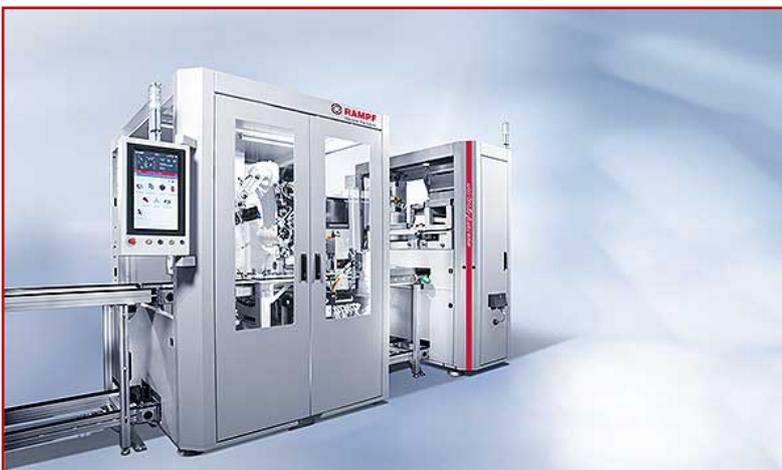
Automatisierte Dosieranlagen für die Verarbeitung von ein-, zwei- und mehrkomponentigen Kunststoffsystemen von RAMPF Production Systems
