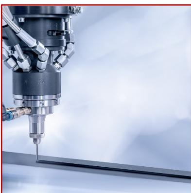
> FIPG- und FIPFG-Dichtungen: RAMPF fertigt kundenindividuelle In-situ-Dichtungen aus Polyurethan mittels FIPG- (Formed-In-Place-Gasket-) und FIPFG- (Formed-in-Place-Foam-Gasket-) Technik. Die Dichtungsschäume werden von CNC-Dosierrobotern direkt auf das Bauteil des Kunden aufgetragen,
