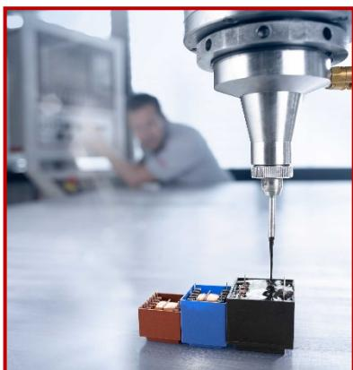
RAMPF verarbeitet reaktive, thermisch und elektrisch leitfähige Polymere mit eigenen hochmodernen Misch- und Dosieranlagen. Diese gewährleisten die präzise und schnelle Verarbeitung hochgefüllter Materialien. Die produzierten Teile werden zuverlässig vor Kontakt, Feuchtigkeit und Beschädigung geschützt und garantieren so die dauerhafte und leistungsfähige Funktion elektronischer Baugruppen.
