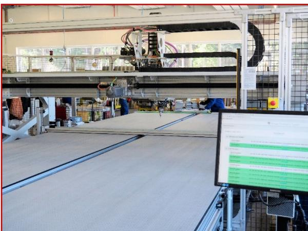
Ultraschnell und ultrapräzise appliziert der Dosierroboter DR-CNC von RAMPF Production Systems den antibakteriellen Polyurethan-Dichtungsschaum von RAMPF Polymer Solutions auf die Thermopaneele. Im Vordergrund ist der Weger Produktion (WPS) Terminal zu sehen, der die Produktionsdaten in Echtzeit erfasst und anzeigt.
