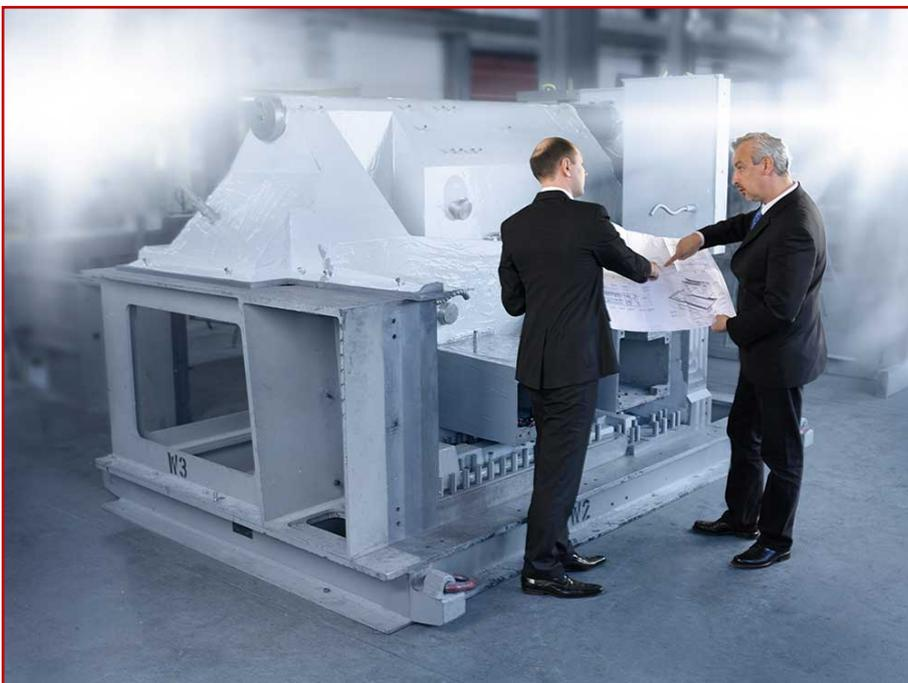
Führende Maschinenbauer nutzen EPUMENT<sup>®</sup> Mineralguss für die Konstruktion von Maschinenbetten und Gestellbauteilen wie Ständern, Portalen und Traversen. Mineralguss ermöglicht eine einzigartige Gestaltungsvielfalt und lässt sich genau an die individuellen Kundenanforderungen anpassen.
