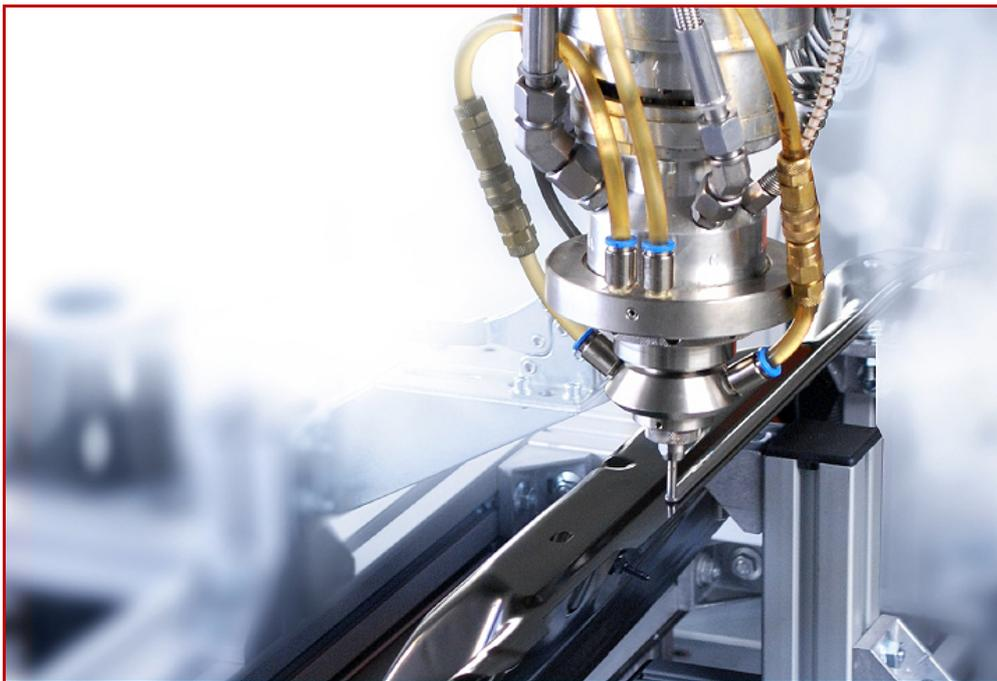
Flüssige bis hochthixotrope sowie kompakte Dichtungen auf Basis von Polyurethan und Silikon schützen maximal und dauerhaft vor Feuchtigkeit, Staub und chemischen Einflüssen.
