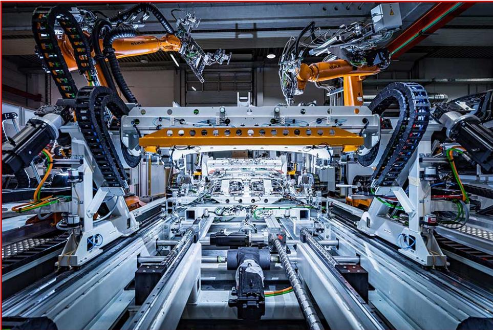
Maßgeschneiderte, schlüsselfertige und hochautomatisierte Produktionsanlagen mit integrierter Dosier-technik zum Dichten, Vergießen und Kleben sorgen für die hochpräzise und ultraschnelle Herstellung von Battery Packs.
