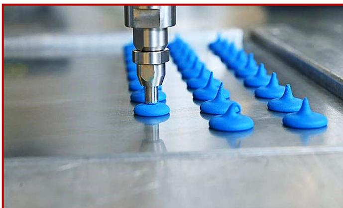
Perfekte Passform, schnelle Aushärtung: RAKU<sup>®</sup> Gap Filler von RAMPF Polymer Solutions werden mit einer Dosieranlage direkt auf die Bauteile aufgetragen und härten unter Raumtemperatur innerhalb von einer Stunde aus.
