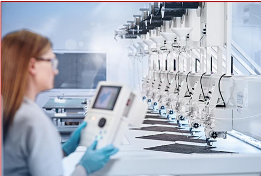
Die Aerospace- und Composite-Engineering-Experten von RAMPF Composite Solutions entwickeln bahnbrechende Konstruktions- und Fertigungslösungen für Unternehmen der Luft- und Raumfahrt-, Sicherheits-, Transport-, Medizintechnik- und Green-Technology-Industrie. Mit der neuen achtköpfigen Tailored-Fiber-Placement-Anlage werden die anspruchsvollsten Leichtbauherausforderungen fortan noch besser und schneller umgesetzt.
