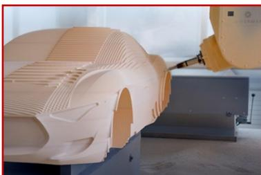
Blockmaterialien aus Polyurethan und Epoxid punkten mit herausragenden mechanischen Eigenschaften, feinsten Oberflächenstrukturen und guter Dimensionsstabilität. Die Boards sind einfach und schnell zu bearbeiten und mit allen branchenüblichen Farben, Trennmitteln und Epoxid-Prepregs kompatibel. RAMPF-Blockmaterialien werden unter anderem für die Herstellung von Styling-, Master-, Cubing- und Präsentationsmodellen, Negativformen zum Gießen, Design-
