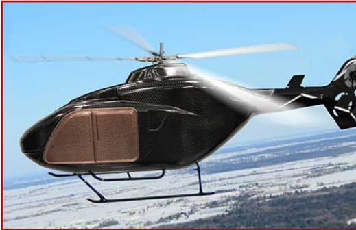
Auf der diesjährigen Messe präsentiert RAMPF Group, Inc. ein High-Tech-Composite-Bauteil, bei dessen Herstellung die RAKU<sup>®</sup> TOOL Resin-Infusion-Systeme EI-2510/EH-2990 und EI-2511/EH-2990 eingesetzt wurden. Diese punkten mit einer hervorragenden Bruchzähigkeit und Viskosität und sind temperaturbeständig bis 209 °C. Die Gelzeit bei 60 °C beträgt 110 Minuten.
