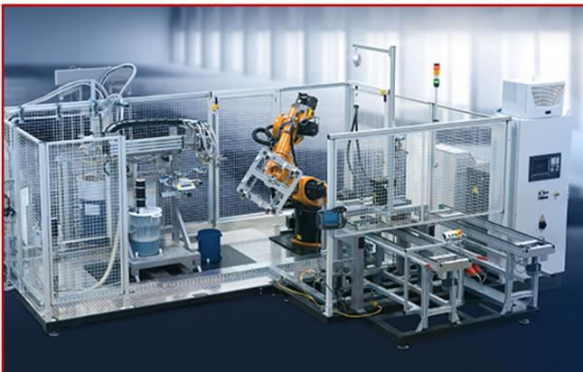
Das kompakte Dosiersystem C-DS ist ausgelegt auf die Verarbeitung von ein- und zweikomponentigen Klebstoffen, Vergussmassen und Dichtmaterialien. Die Anlage ist variabel einsetzbar – vom Handarbeitsplatz über die automatisierte Teillösung bis zur vollautomatisierten Roboteranlage.
