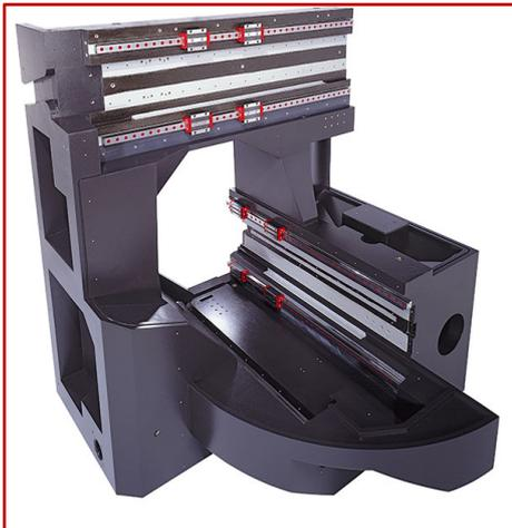
Herausragende Schwingungsdämpfung, hoher Funktionsintegrationsgrad, nachhaltige und umweltschonende Produktion: Das Bett dieser Hochgeschwindigkeitsfräsmaschine ist aus EPUMENT<sup>®</sup> Mineralguss hergestellt.
