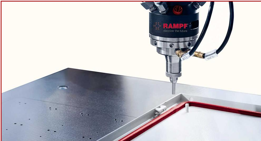
FlexSpeed-Technologie von RAMPF Production Systems beruht auf der volumetrischen Zwangsdosierung und der direkten Kopplung von Dosierleistung und Achsvorschub, wodurch das Dosiersystem extrem flexibel und reaktionsschnell ist. Wo ein Dosierroboter üblicherweise mit gleichmäßiger Geschwindigkeit appliziert, ist er mit FlexSpeed-Technik mit bis zu 40 m/min. auf der Geraden unterwegs, um kurz vor Ecken und Rundungen kontrolliert auf 20 m/min. abzubremsen.
