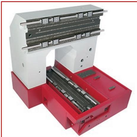
EPUMENT<sup>®</sup> Mineralguss von RAMPF Machine Systems ist aus ausgewählten Mineralien und Gesteinen sowie hochwertigen Bindemitteln auf Epoxidharzbasis zusammengesetzt. Gegenüber Grauguss und Schweißkonstruktionen besitzt der innovative Werkstoff eine deutlich bessere Dämpfung, wodurch eine höhere dynamische Stabilität der Gestellstruktur in ultraschnellen und hochpräzisen Produktionsmaschinen gewährleistet wird.
