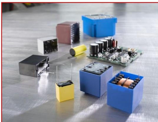
Elektrogießharze schützen empfindliche elektrische und elektronische Bauteile gegen chemische Substanzen und Umwelteinflüsse wie Kälte oder Feuchtigkeit. Die leistungsstarken Kunststoffsysteme spielen zudem auch eine wichtige Rolle beim Wärmemanagement: Indem sie die Hitzequelle in den Bauteilen umschließen und die entstehende Wärme ableiten, gewährleisten sie die langlebige Leistung der elektrischen/elektronischen Systeme.
