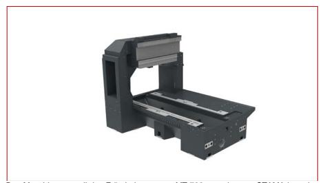
Das Maschinengestell des Fräsdrehzentrums MT 733 one plus von STAMA besteht aus einem Bett und einem Portal, gefertigt aus EPUMENT® Mineralguss von RAMPF Machine Systems.
