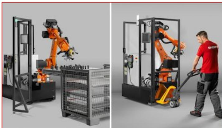
Flexibilität durch Mobilität: Der kameragesteuerte Sechsarmeroboter SherpaLoader<sup>®</sup> steht auf einem Maschinengestell aus EPUMENT<sup>®</sup>-Mineralguss und kann per Hubwagen einfach an die zum Einsatz kommenden Produktionsmaschinen positioniert werden.
