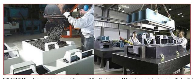
EPUMENT Mineralguss besteht aus speziell ausgewählten Gesteinen und Mineralien sowie hochwertigen Bindemitteln auf Epoxidharzbasis. Es wird kalt in Gießformen aus Holz, Stahl oder Kunststoff vergossen (links). Dadurch wird im Vergleich zu anderen Werkstoffen bis zu 30 Prozent weniger Primärenergie bei der Herstellung verbraucht.
