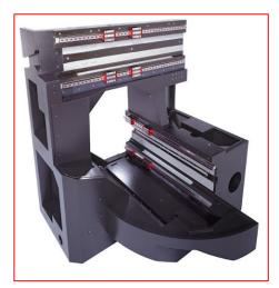
Höchste Dynamik – nachhaltig und umweltschonend produziert: Das Bett einer Hochgeschwindigkeitsfräsmaschine aus EPUMENT Mineralguss mit hochpräzisen, spanlos hergestellten, abgeformten Flächen zur Montage von Führungsschienen, Messsystemen und Antriebskomponenten.
