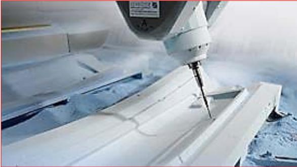
Fräsen eines Prepreg-Legewerkzeugs aus RAKU<sup>®</sup> TOOL WB-0691 für die Produktion von Composite-Teilen.
