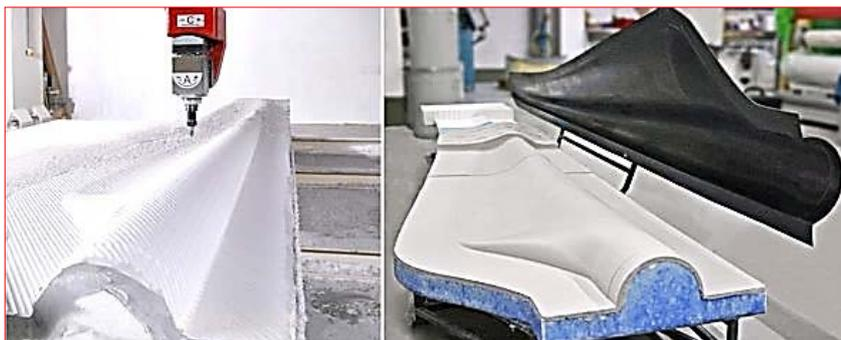
Diese Form für die Produktion von Rotorblättern für Windenergieanlagen in Verbundbauweise wurde mit der Close Contour Paste RAKU<sup>®</sup> TOOL CP-6060 hergestellt.
