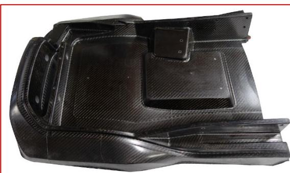
Extrem leicht, extrem stabil: Diese Rückenlehne für Sitze in einem Geschäftsflugzeug wurde von RAMPF mit dem vakuumunterstützten Harzinjektionsverfahren (VARTM) und dem Resin-Infusion-System RAKU<sup>®</sup> FST 5501 hergestellt. In dem Bauteil werden eine Sandwichstruktur (Karbonfaserschichten / Schaumkern / Karbonfaserschichten) und eine monolithische Schicht (Karbonfaser) verbunden.
