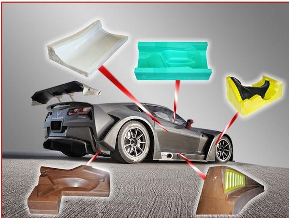
In Deutschland arbeitet RAMPF auch mit [Callaway Competition](#) zusammen, dem Racing-Team mit Sitz in Leingarten (Baden-Württemberg). Für ihr aktuelles Fahrzeug [Corvette C7 GT3-R](#) wurden RAKU<sup>®</sup> TOOL Block- und Flüssigmaterialien für die Herstellung verschiedener Leichtbauteile verwendet.
