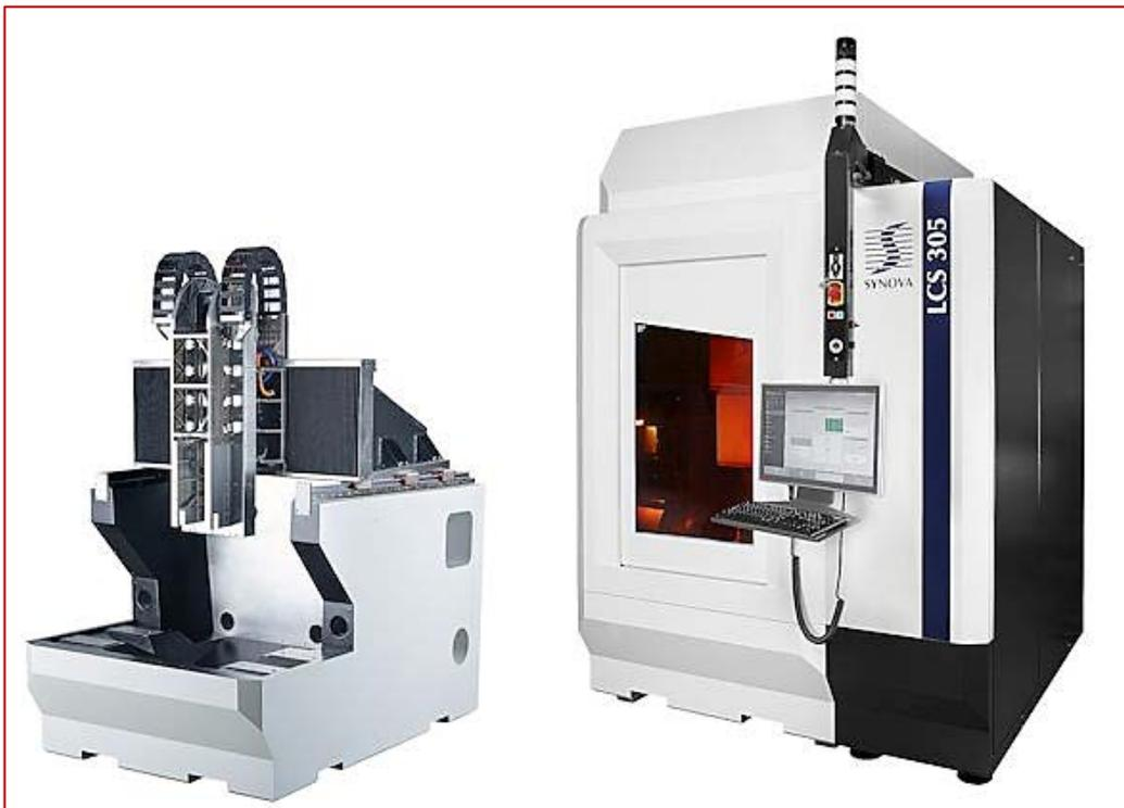
Steht auf einer schwingungsarmen Maschinenbasis aus EPUMENT-Mineralguss: das neueste Laserschneidsystem LCS 305 des Schweizer Unternehmens SYNOVA.
