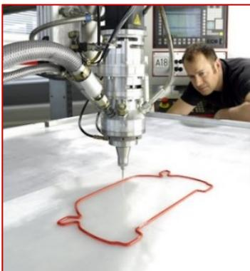
RAMPF fertigt kundenindividuelle In-situ-Dichtungen aus Polyurethan mittels FIPG- (Formed-In-Place-Gasket-) und FIPFG- (Formed-in-Place-Foam-Gasket-) Technik. Die Dichtungsschäume werden von
