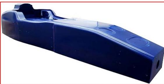
Für diesen Monocoque-Körper eines Rennwagens wurde RAKU<sup>®</sup> TOOL Close Contour Casting CC/CB-6503 verwendet, um die Urmodelle für Prepreg-Legewerkzeuge herzustellen. Close Contour Castings werden dem Kunden als dreidimensionaler Gießling geliefert, der bereits eine konturnahe Form des endgültigen Modells hat.
