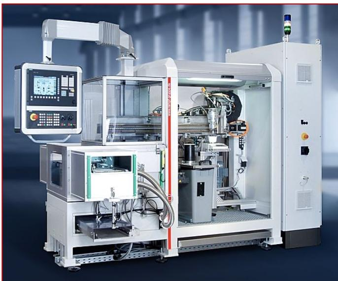
Dosieren unter Vakuum für anspruchsvolle Materialien mit der Vakuumdosieranlage DC-VAC von RAMPF.
