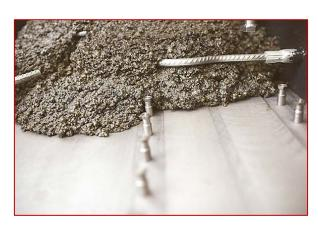
Zusätzlich zu den herausragenden Dämpfungseigenschaften punktet der epoxidharzgebundene Werkstoff EPUMENT von RAMPF mit einer geringen Wärmeleitfähigkeit, hohen Isotropie, Homogenität und Medienbeständigkeit, flexiblen Formgebung, spanlosen Abformung, innovativen Klebetechnologie sowie exzellenten Ökobilanz.
