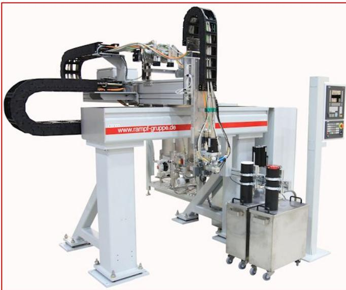
Mit modernster Steuerungstechnologie kombiniert der DR-CNC das Misch- und Dosiersystem mit den wartungsfreien CNC-Linearachsen. Das Ergebnis: ein optimales Zusammenspiel von Dosierprozess und Bewegungsabläufen.
