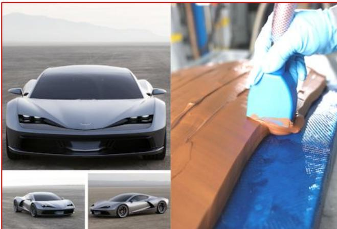
Die RAKU<sup>®</sup> TOOL Close Contour Paste CP-6070/6072 von RAMPF wurde für die Produktion des Konzeptfahrzeugs "Fast Eddy" des kalifornischen Unternehmens Aria Group eingesetzt. © Aria Group, RAMPF
