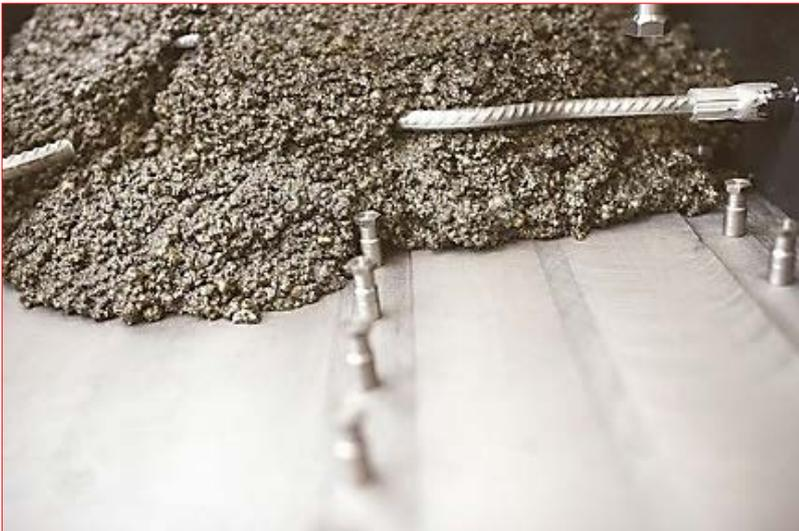
EPUMENT, der epoxidharzgebundene Mineralguss von RAMPF, wird für die Herstellung schwingungsdämpfender Maschinenbetten und Gestellbauteile im hochdynamischen Maschinenbau eingesetzt.
