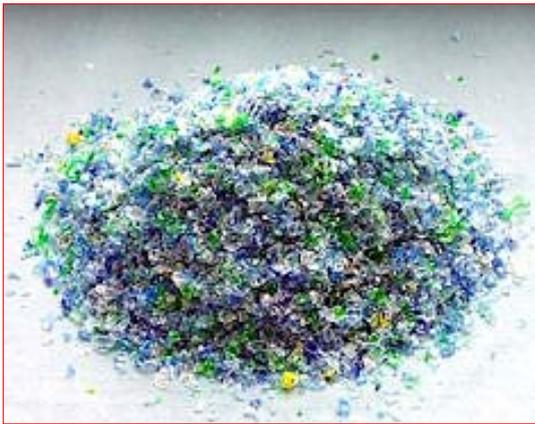
Produktionsreststoffe und Post-Consumer-PET aus Verpackungen sind für RAMPF Eco Solutions keine Abfälle, sondern wertvolle Rohstoffquellen. Diese werden durch ein spezielles chemisches Verfahren zu Polyol aufbereitet, das dann erneut in der Polyurethanherstellung eingesetzt wird.
