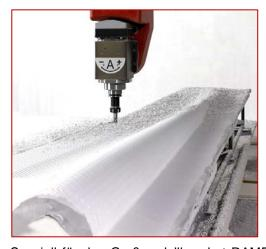
Speziell für den Großmodellbau hat RAMPF Tooling Solutions die Close Contour Paste RAKU® TOOL CP-6060 entwickelt. Für die Herstellung dieses Modells eines Windturbinenblattes wurde die Epoxidpaste verwendet, um Windturbinenblätter in Composite-Bauweise zu produzieren.
