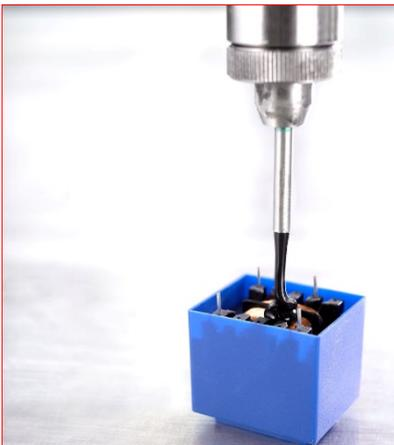
2K-Polyurethan-Vergusssysteme von RAMPF Polymer Solutions schützen empfindliche elektronische Bauteile vor Vibration und thermischem Schock – auch bei extrem niedrigen Temperaturen. Die RAKU<sup>®</sup> PUR Systeme sind jetzt noch leistungsfähiger, robuster und temperaturunabhängiger und werden unter anderem in der Automobilindustrie bei Steuergeräten, Platinen und Sensoren eingesetzt.
