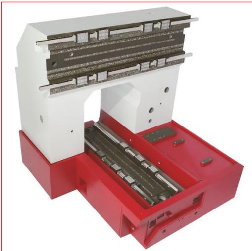
Auf der soliden Basis von Maschinenbetten und Gestellbauteilen aus leistungsfähigen Werkstoffen wie Mineralguss, Ultra-hochleistungsbeton, natürlichem Hartgestein und Faserverbundmaterialien liefert RAMPF Machine Systems seinen Kunden weltweit innovative Systemlösungen, Basismaschinen sowie Positionier- und Bewegungssysteme. Das Unternehmen der internationalen RAMPF-Gruppe ist der weltgrößte Produzent von Mineralguss.
