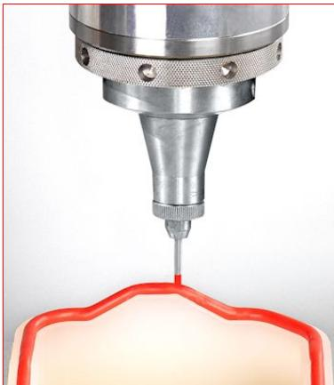
Mit Misch- und Dosiertechnik von RAMPF Production Systems können alle handelsüblichen Polyurethan- und Silikonschäume zu Dichtungen verarbeitet werden.
