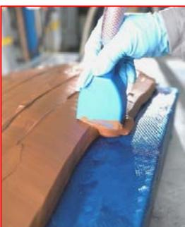
RAKU-TOOL<sup>®</sup> Close Contour Paste wird auf einen konturnahen Unterbau aufgetragen, gehärtet und anschließend gemäß den CAD-Daten gefräst. Aufgrund der konturnahen Form des Modells wird weniger Material verbraucht, das Fräsen geht schnell und einfach, und es entsteht weniger Abfall.
