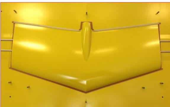
Für die Herstellung eines Flügelmittelstücks für ein Modellflugzeug wurden das Blockmaterial RAKU-TOOL<sup>®</sup> WB-1404, das Oberflächenharz RAKU-TOOL<sup>®</sup> EG-2102 / EH-2950-1 sowie das Resin-Infusion-System RAKU-TOOL<sup>®</sup> EI-2500 / EH-2973 eingesetzt.
