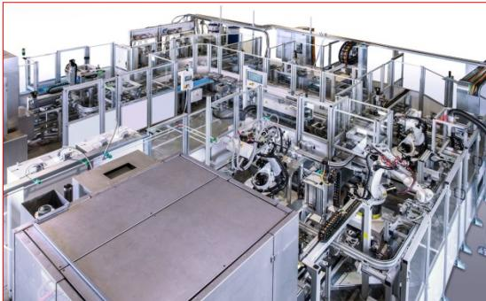
Die RAMPF Group, Inc. bietet ihren Kunden auch schlüsselfertige Lösungen für alle Optical-Bonding-Prozesse. Zusätzlich zum Display-Fügeverfahren unter Vakuum beinhalten die von RAMPF konzipierten vollautomatischen Produktionssysteme alle Arbeitsschritte zum Verkleben des Displays mit dem Rahmen.
